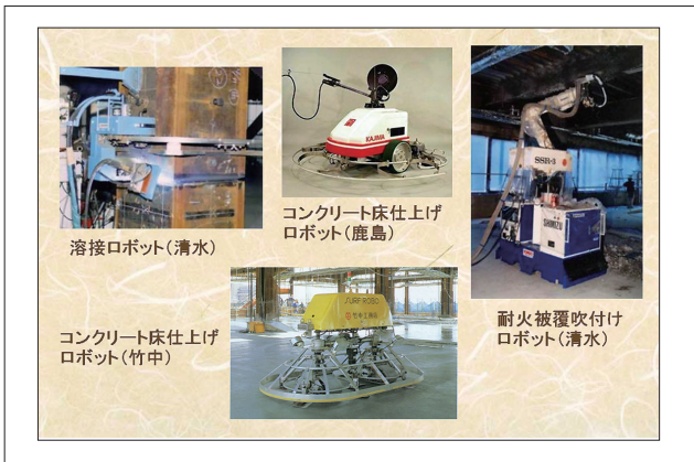
図36 躯体作業用ロボット開発例(前田純一郎氏提供)
