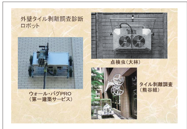
図38 検査用ロボットの開発例(前田純一郎氏提供)
