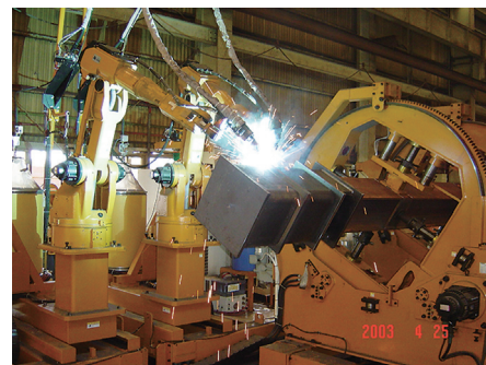
図30 鉄骨ファブリケーターではロボット活用で24時間稼働が増えている
