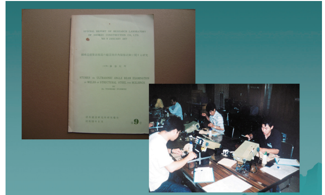
図38 鉄骨溶接部の超音波探傷試験方法の確立と普及
