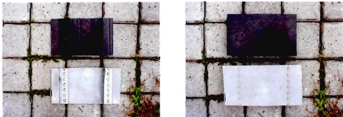
図1 金属構造とCFRP補強平板の表裏画像（CFRPはノンファスナー）
