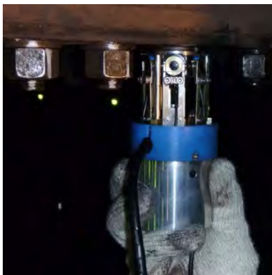
図17 ボルト軸力計（株）ジャスト殿との技術提携により製品化）
