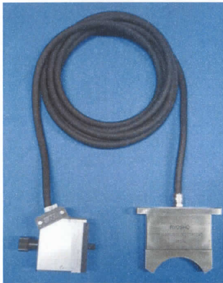
図2. アレイ探触子の外観図
