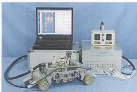
図7 配管厚さ測定ロボット
