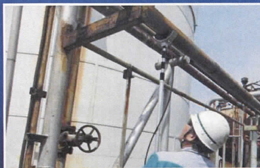
配管架台接触部用 MsTセンサ
